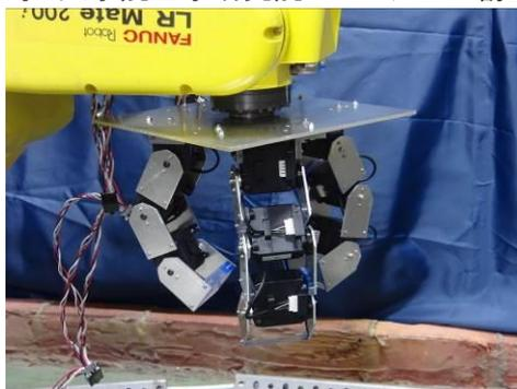
三次元的なIn-Handケーシングマニピュレーションの実験的検証を行うために、同じくコマンド方式サーボモータを利用した、4指12関節のプロトタイプロボットハンドを開発した。このハンドは6軸垂直多関節型の産業用ロボットに装着されている。これを用いて、三次元空間内におけるIn-Handケーシングマニピュレーションが可能であることを確認した。
